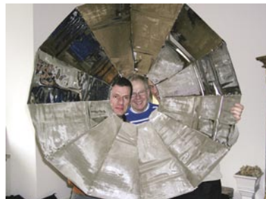
Bau eines Parabolspiegels mit Hilfe eines Kartons und Spiegelfolie
