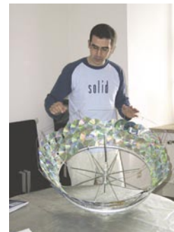
Bau eines Parabolspiegels mit Hilfe eines Regenschirmes und alten CD's
